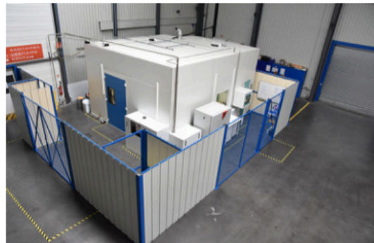
Salle blanche installée chez RJ Industrie pour valider le processus en pré-production.
