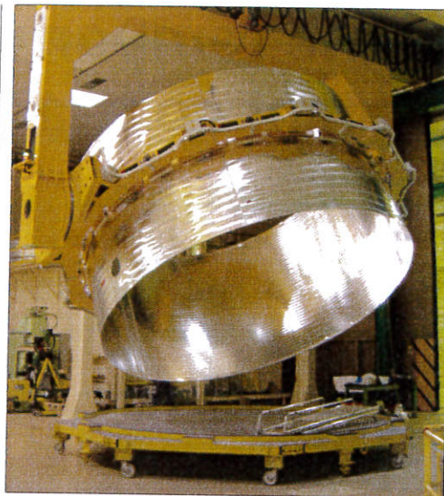
Palonnier de manutention et de basculement des viroles.
