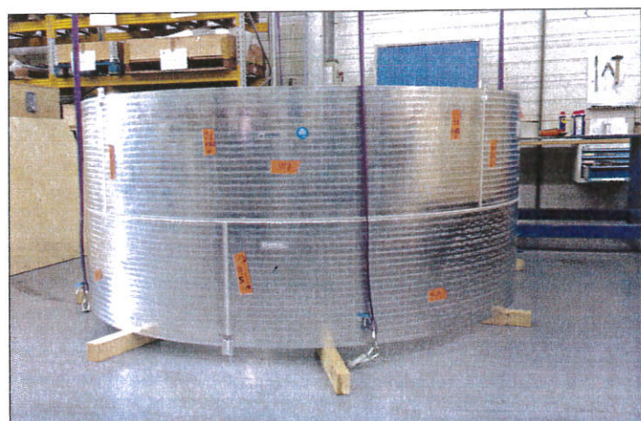
Vérification de la qualité des soudures par découpe locale et examen micrographique.
