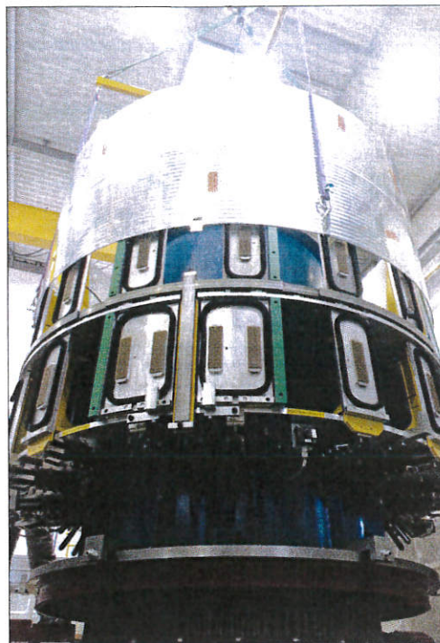
Extraction du démonstrateur après retour de l'outillage en position verticale.
