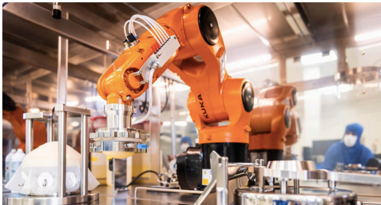
Équipement technologique clé de la nouvelle usine de Carmat à Bois-d'Arcy, la station robotisée d'assemblage des membranes hybrides de la bioprothèse cardiaque a été réalisée avec le groupe Roux-Jourfier. - Nicolas Broquedis
