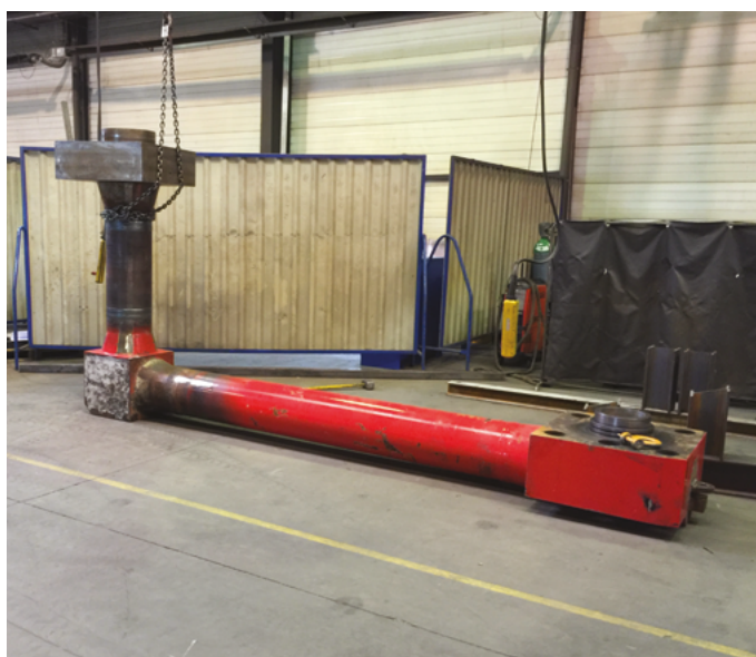
Tube P305GH forgé, épaisseur 60 mm, pression d'utilisation 630 bar pression d'épreuve 1000 bar
