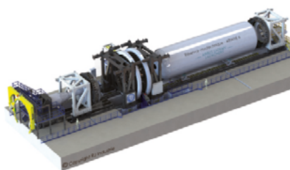
Banc de soudage FSW pour Ariane 6
