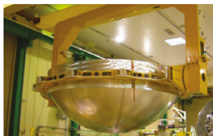
Palonnier de manutention pour réservoir Ariane 5
